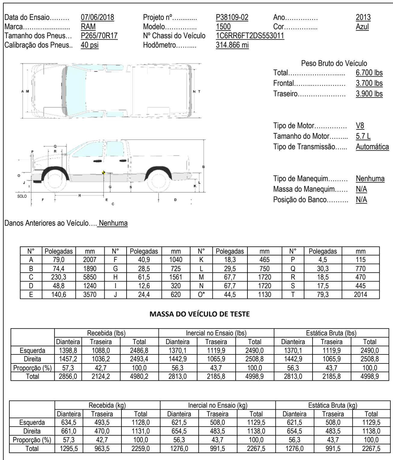
Figura 1 Informações sobre o Veículo no Ensaio 3-33
