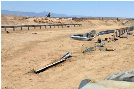
FIGURA 30. Pós-Teste - Vista Esquerda Frontal de  $\frac{3}{4}$  do Artigo de Teste
