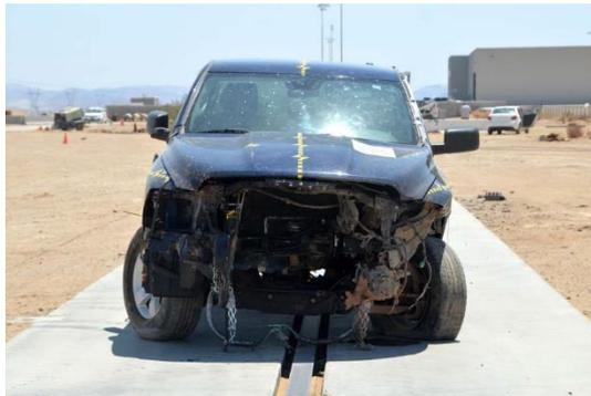
FIGURA 42. Pós-Teste - Vista Frontal do Veículo de Prova
