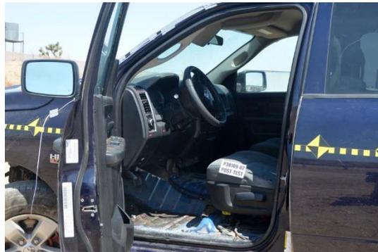
FIGURA 50. Pós-Teste - Compartimento de Ocupantes no Lado do Condutor
